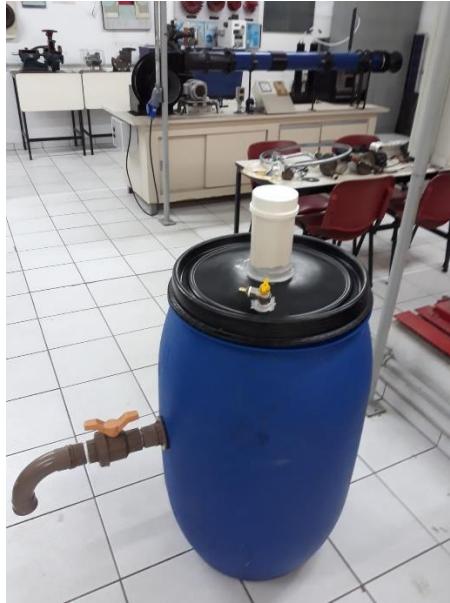
Figura 16 - Pré-montagem do biodigestor
