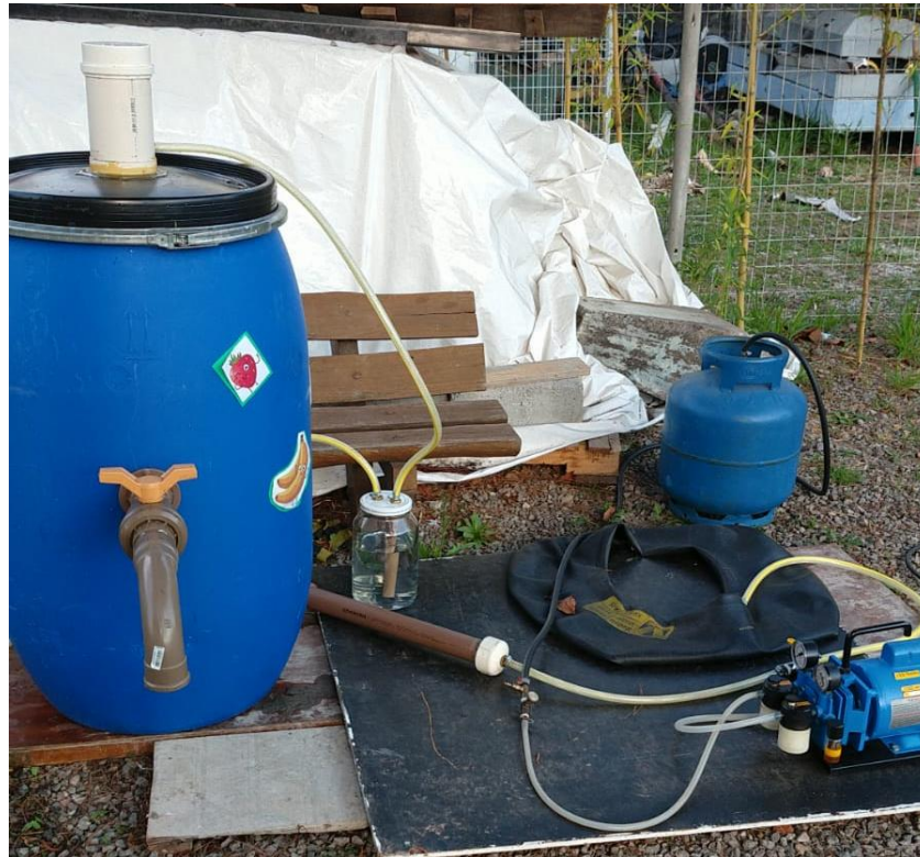
Figura 18 - Biodigestor posicionado com bomba de vácuo para drenagem de gás
