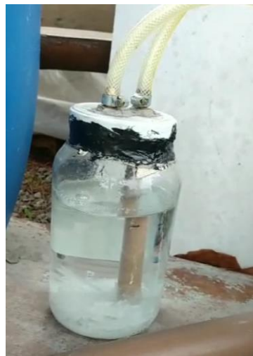
Figura 20 - Aparecimento de cristais no filtro de soda cáustica
