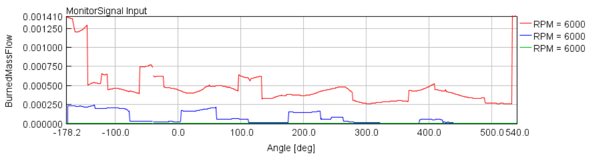
Figura 19 – Massa de ar queimado por ângulo do virabrequim para cada caso a 6.000 rpm
