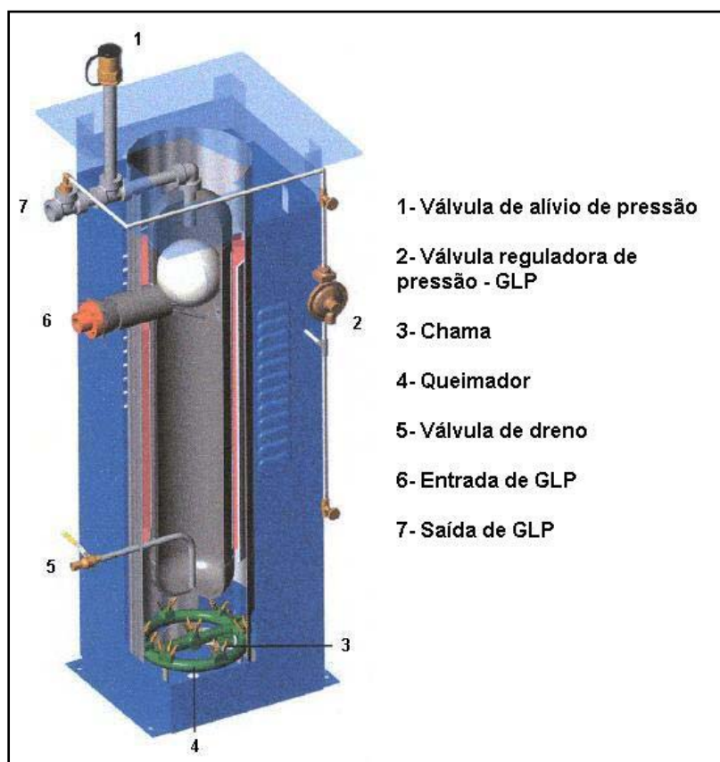
FIGURA 3.2 – VAPORIZADOR DE GLP DE CHAMA DIRETA
