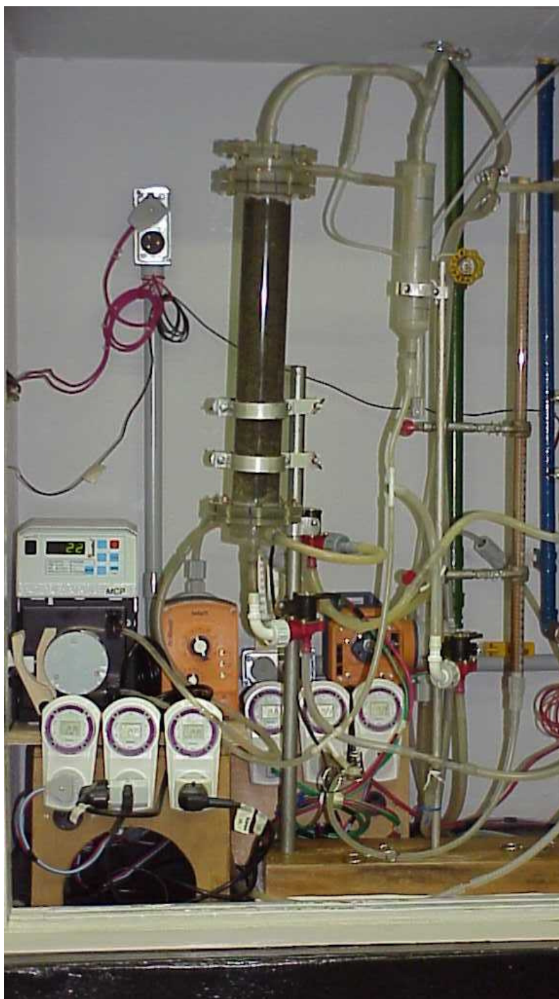
FIGURA 4.9: Fotografia do sistema de reação utilizado nos ensaios de operação do reator anaeróbio em batelada seqüencial com circulação da fase aquosa.
