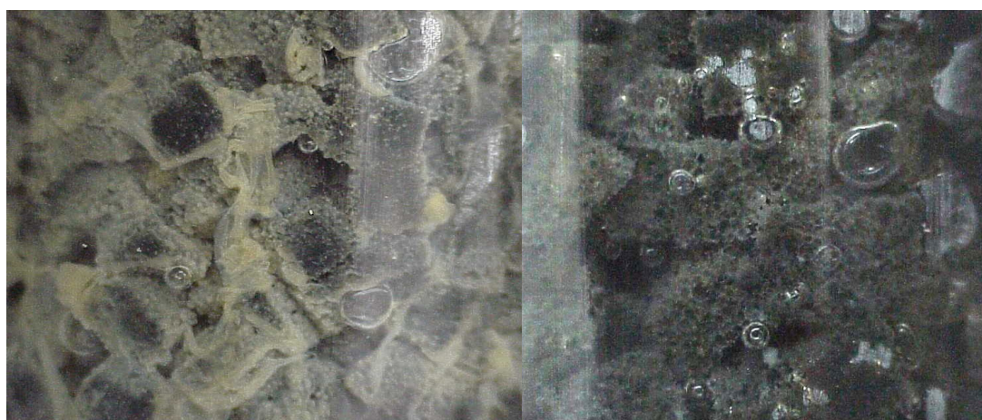
FIGURA 5.53: Fotografia do leito de espuma de poliuretano compactado na operação com velocidade superficial de recirculação de 0,300 cm/s nos ensaios de avaliação da influência da velocidade superficial no desempenho do reator.
