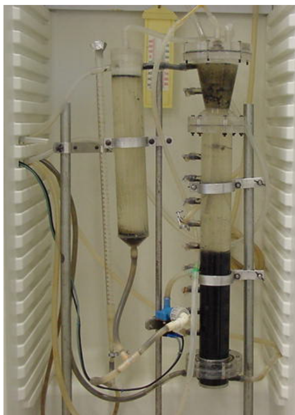
Figura 4.3 – Fotografia do sistema completo, contendo biomassa granulada, operado em batelada seqüencial (a) com velocidade de recirculação de 10 m/h e (b) etapa de sedimentação
